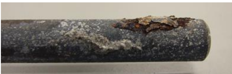
Korrosion på armering exponerad i betong med 97% fuktighet och 1 % klorid per cementvikt
